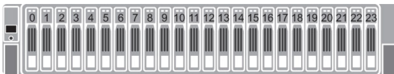
Figure 11. Numérotation des lecteurs des Systèmes de stockage SC4020
